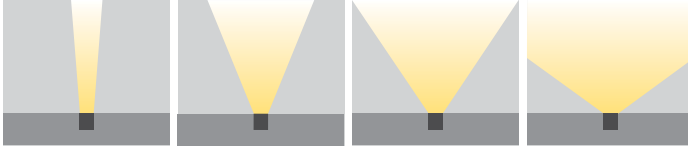
XN: Ekstra Dar Açılı M: Orta Açılı W: Geniş Açılı XW: Lenssiz
